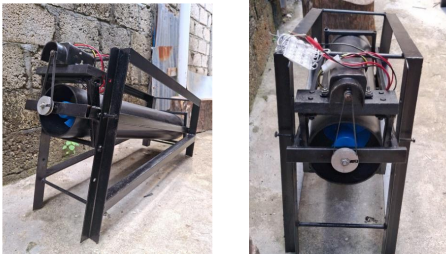
Gambar 2. Turbin Ulir Skala Pikohidro Yang Siap Diuji (Sumber: Dokumentasi penelitian, 2024)
